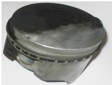
Odstranění karbonu z pístu. Expozice 12 hodin.
