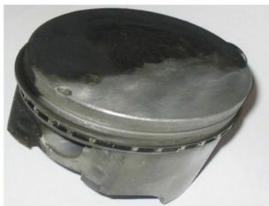
Odstranění karbonu z pístu. Expozice 12 hodin.
