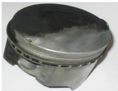
Odstranění karbonu z pístu. Expozice 12 hodin.
